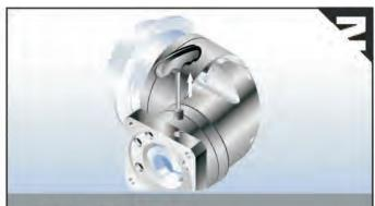
アダプターのブラグを取り外す。 セットカラーを回して、ブラグの穴とボルトヘッドを合わせる。
