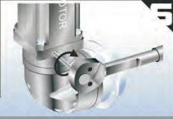
トルクレンチを使い、規定値のトルクでセットカラーのボルトを 締める。(トルク表 Table 2 参照)
