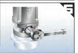
トルクレンチを使い、規定値のトルクでセットカラーのボルトを 締める。(トルク表 Table 2 参照 )
