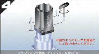
マウンティングボルト(ワッシャーを含む)を、 規定値の5%でトルクレンチを使い、1~4の順番 で締める。(トルク表Table 1 参照)
