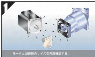
モータと減速機のサイスを再度確認する。 取付面(モータ締結部分)をきれいにする。 (※モータ出力軸及び減速機入力軸の脱脂処理を行う)
